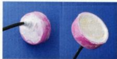
Obr. 4. Piezoměnič s mezikroužkem jsem vlepil do víčka od PET lahve a utěsnil sanitárním silikonovým tmelem (na plastu bohužel moc nedrží)
