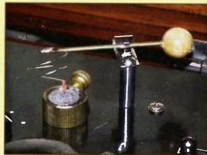
Obr. 5. Poměrně jednoduchý typ galenitového detektoru
