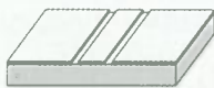
Obr. 50. Koplanární vedení je na desce se spoji po jedné straně, pásek se signálem je obklopen zemnicí plochou
