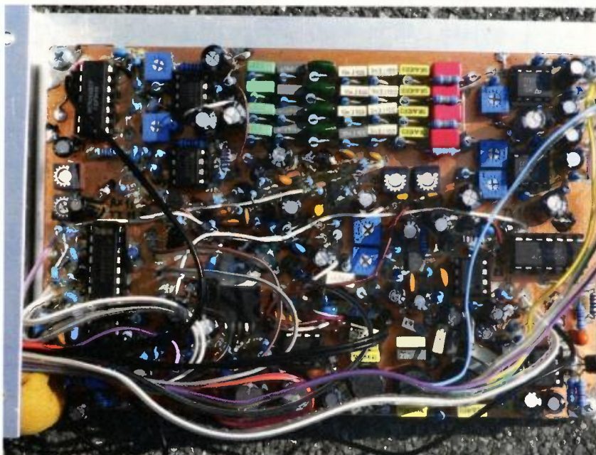
Obr. 5. Fotografie osazené nf desky (OK1ZKQ). Rozměry desky: 88 x 135 mm
