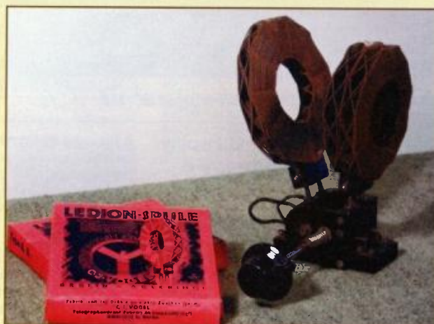
Obr. 8. Ladění dvěma voštinovými cívkami [2]
