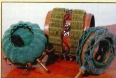
Obr. 9. Ladění pomocí variometrů [2]
