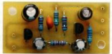
Obr. 9. Deska předzesilovače pro reproduktor v roli mikrofonu
