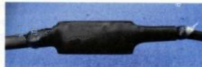
Obr. 3. Na konce kabelů jsem nanestalavné lepidlo a zesilovač hermeticky zatavil do smršťovací bužírky
