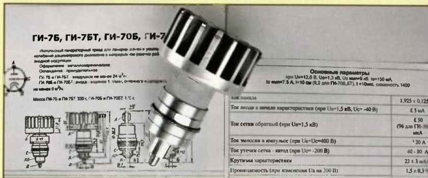
Obr. 30. Sovětská elektronka GI7B z radiolokátoru P20
